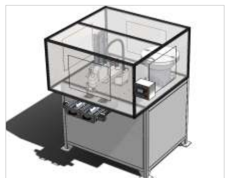
APLICAÇÃO AUTOMÁTICA DE COLA
